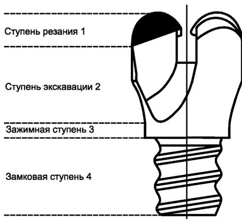
Рисунок 2 — Конструкция бурового резца
